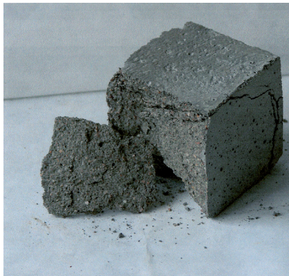
Рис. 2. Характер разрушения образцов при испытании на сжатие после прогрева до 400°C.
