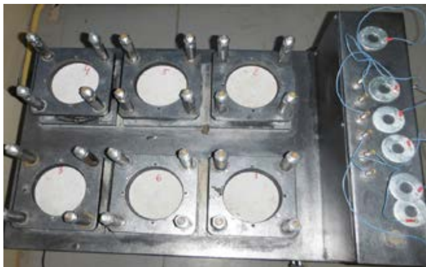
Фото 1. Установка для испытаний образцов на водонепроницаемость.
