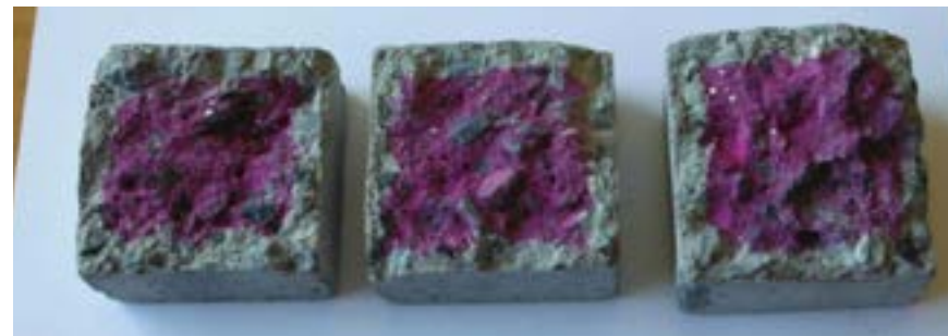
Фото 14. Внешний вид контрольных бетонных образцов (без покрытия) после 14 суток испытаний
