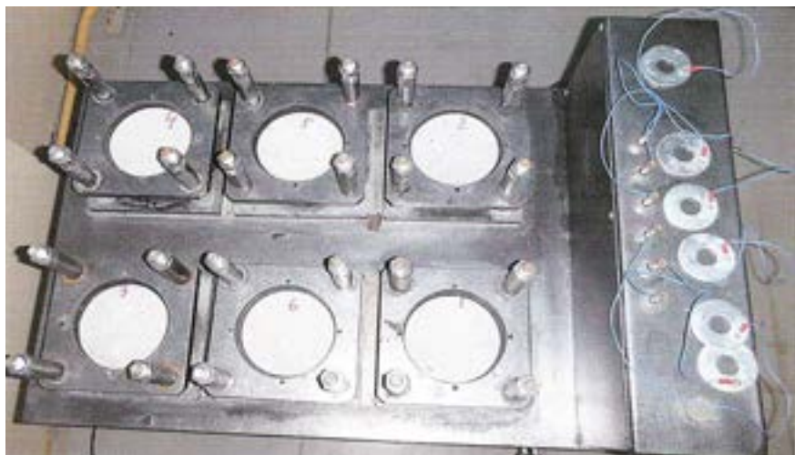
Фото 3. Установка УВФ-6/09 для испытаний образцов на водонепроницаемость.
