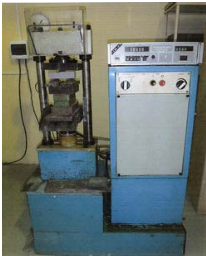
Фото 2. Пресс ИП-1, модель ИП 6010-100-1 для испытаний прочности образцов
