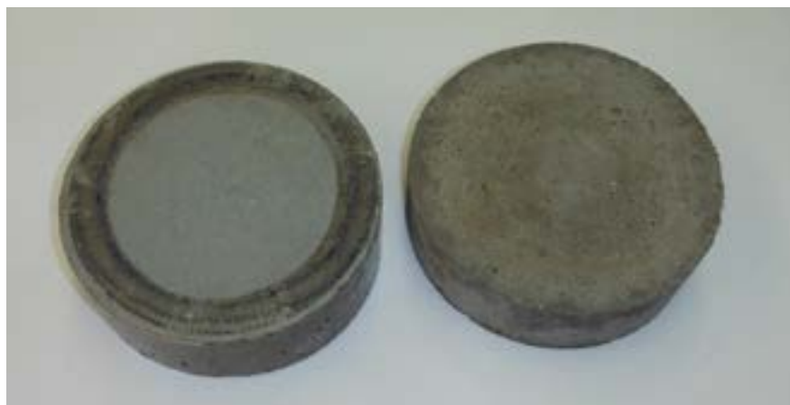
Фото 2. Внешний вид образцов с системой покрытия и на основе водно-дисперсионной краски Colorite Beton и контрольных образцов для испытаний на водонепроницаемость.
