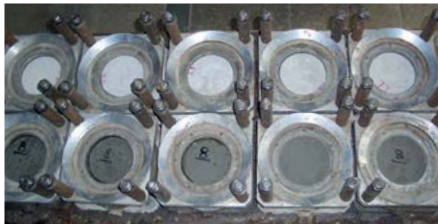
Фото 1. Установка для испытаний образцов на водонепроницаемость.
