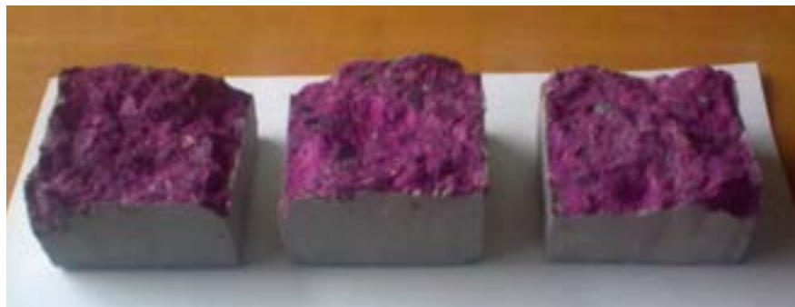
Фото 10. Внешний вид бетонных образцов с системой покрытия Colorite Beton после 7 суток испытаний
