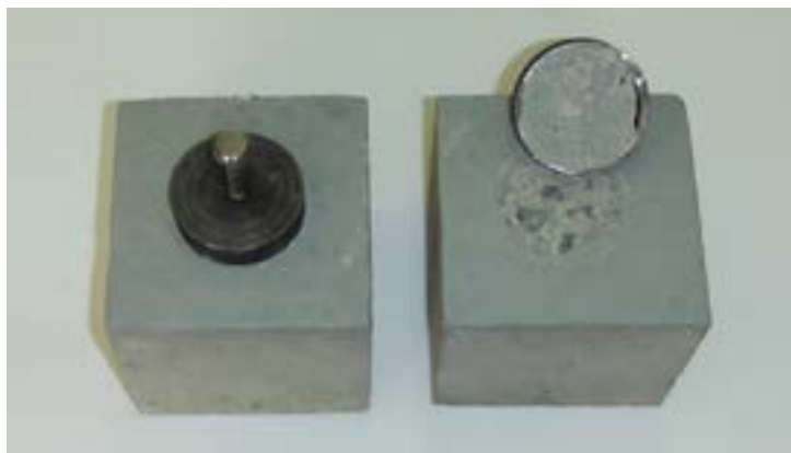
Фото 10. Внешний вид образцов бетона с системой покрытия на основе водно-дисперсионной краски Colorite Beton до испытаний и после испытаний на адгезию.
