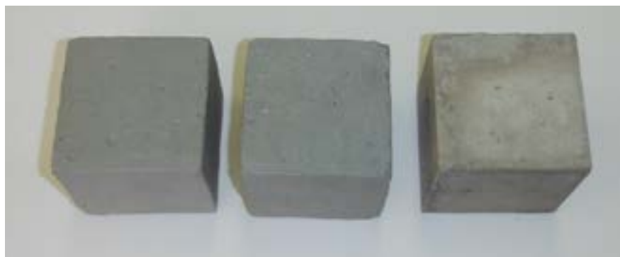
Фото 4. Внешний вид образцов перед испытаниями на морозостойкость.
