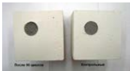
Фото 3. Характер разрушения при испытаниях на адгезию контрольных образцов и образцов после 90 циклов ускоренных климатических испытаний (покрытие Elastocolor Paint). Отрыв по телу бетонного основания; прочность сцепления покрытия с основанием больше полученного значения
