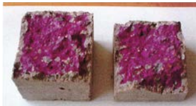
Фото 11. Внешний вид контрольных бетонных образцов (без покрытия) после 7 суток испытаний
