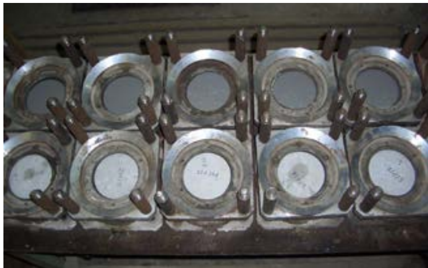
Фото 1. Установка для испытаний образцов на водонепроницаемость.
