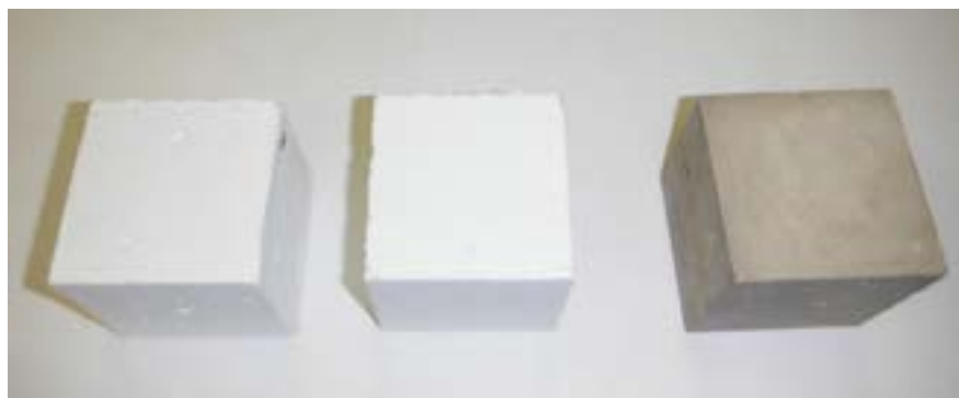
Фото 4. Внешний вид образцов перед испытаниями на морозостойкость.
