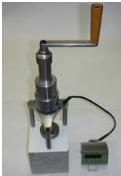
Фото 9. Измеритель прочности сцепления (адгезии) PCS-10MG4.
