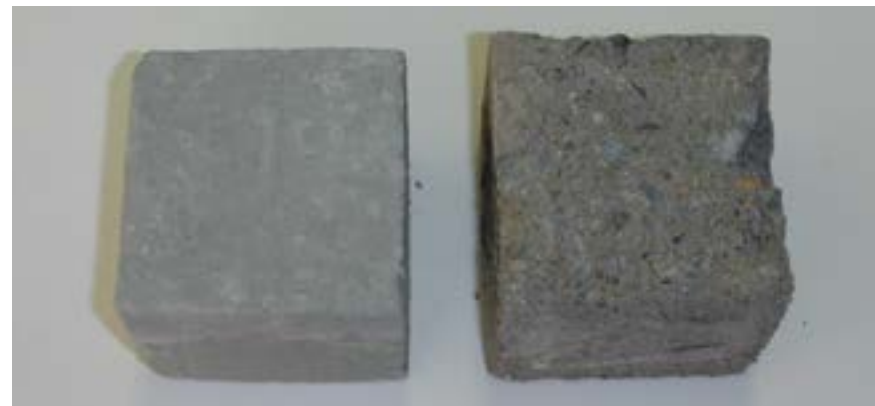
Фото 6. Внешний вид образцов после 10 циклов испытаний на морозостойкость.
