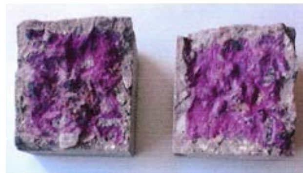
Фото 13. Внешний вид контрольных бетонных образцов (без покрытия) после 14 суток испытаний
