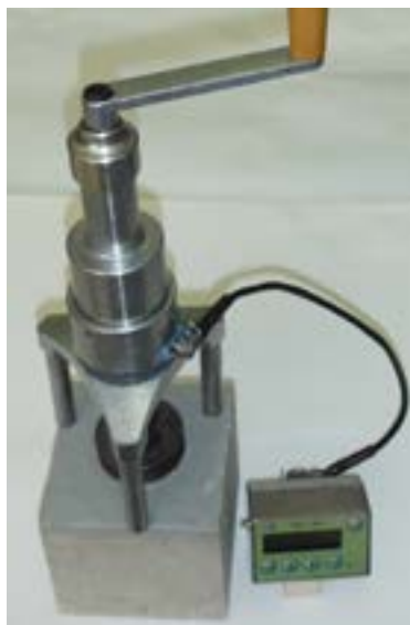
Фото 9. Измеритель прочности сцепления (адгезии) PCS-10MG4.
