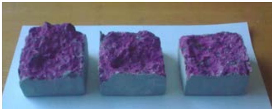
Фото 11. Внешний вид бетонных образцов с системой покрытия Colorite Beton после 14 суток испытаний
