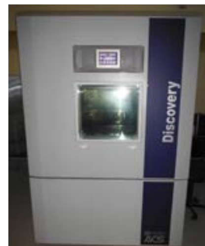
Фото 3. Климатическая камера DV 1600C для испытаний на морозостойкость.
