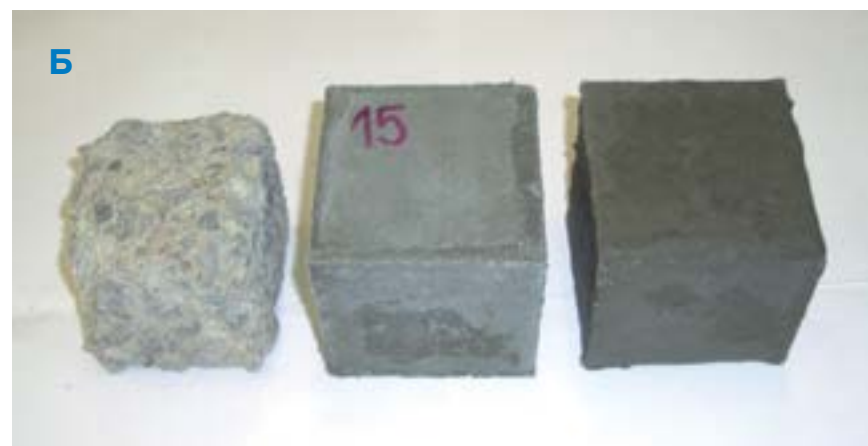
Фото 2. Внешний вид образцов после испытаний на морозостойкость. А — после 10 циклов, Б — после 15 циклов.
