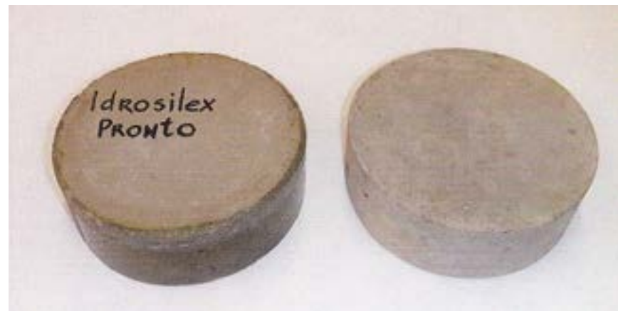
Фото 4. Внешний вид образцов с системой покрытия на основе гидроизоляционного состава Idrosilex Pronto и контрольных образцов для испытаний на водонепроницаемость.
