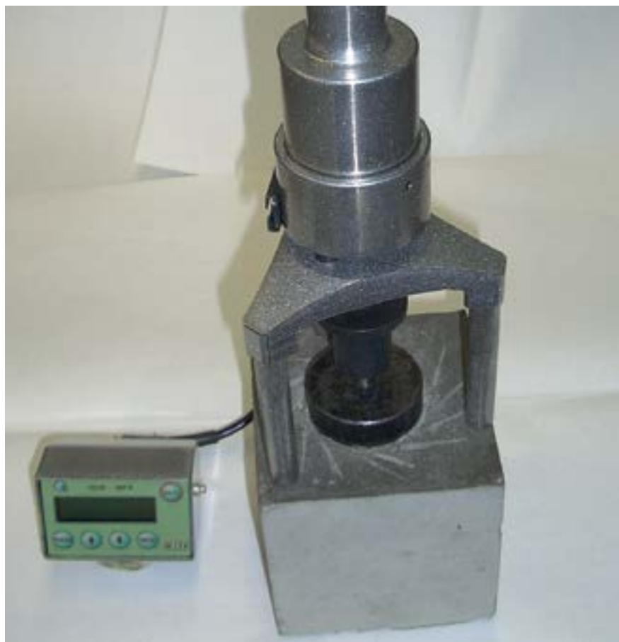
Фото 3. Измеритель прочности сцепления (адгезии) PCS-10MG4.
