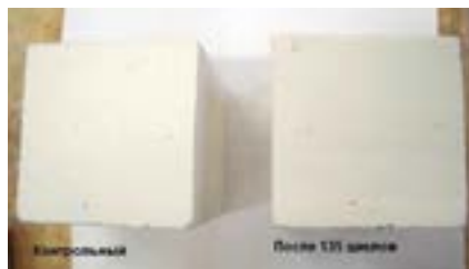
Фото 2. Общий вид лицевой поверхности образцов до испытаний и после 135 циклов ускоренных климатических испытаний (покрытие Elastocolor Paint). Трещин, пузырей, отслоений не наблюдается. Отмечается незначительное изменение декоративных свойств — (посветление покрытия); пятен, меления и других дефектов не отмечается.
