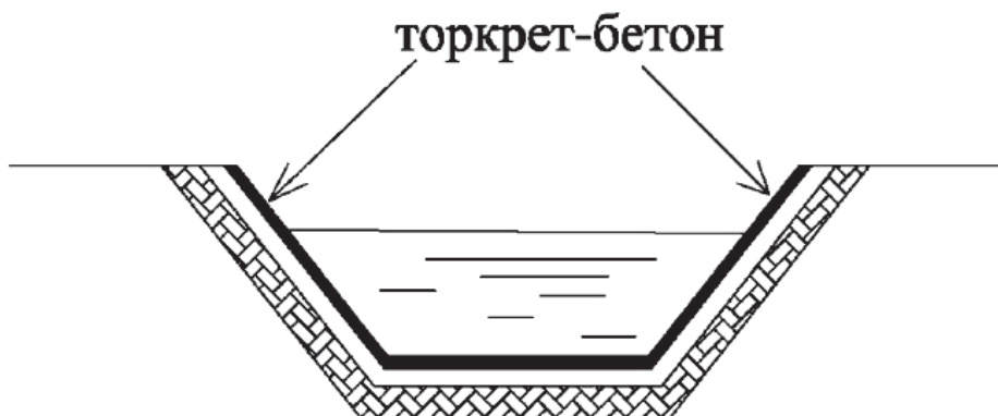
Рис. 6.3 – Торкретирование откосов и днища каналов
