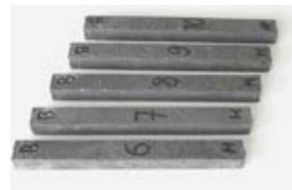
Фото 22. Образцы для испытаний сульфатостойкости по ГОСТ Р 56687-2015 после 6 месяцев испытаний в дистиллированной воде
