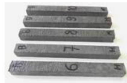
Фото 18. Образцы для испытаний сульфатостойкости по ГОСТ Р 56687-2015 после 5 месяцев испытаний в дистиллированной воде
