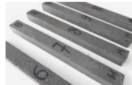
Фото 6. Образцы для испытаний сульфатостойкости по ГОСТ Р 56687-2015 после 2 месяцев испытаний в дистиллированной воде
