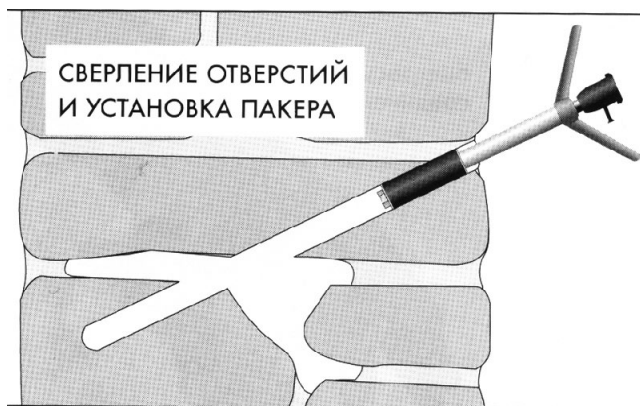
Рис.37. Закрепление пакеров в конструкциях: а) установка пакеров на трещине в бетонной конструкции; б) установка пакеров на трещине в облицовки опоры.
