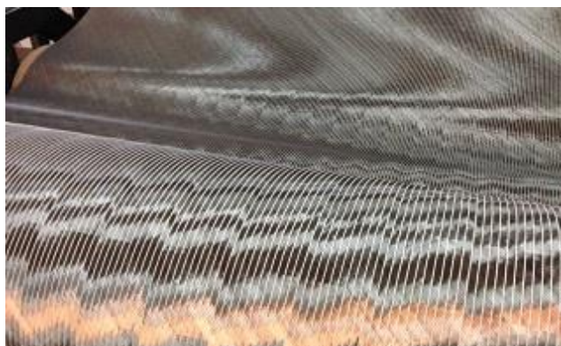
Рисунок 3.6 – Внешний вид мультиаксиальной ткани
