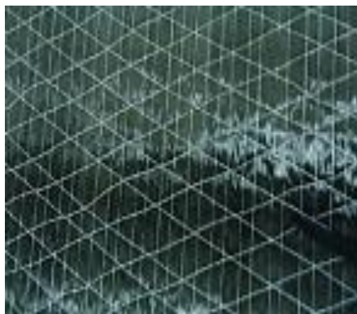
Рисунок 3.4 – Внешний вид углеродной однонаправленной ленты из плоских волокон FibArm Spread Tape
