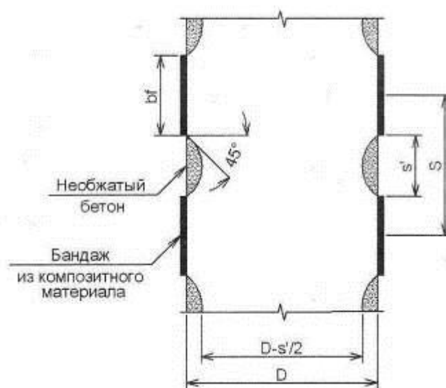
Рис. 6.2.4. Усиление колонны отдельными бандажами по высоте.
