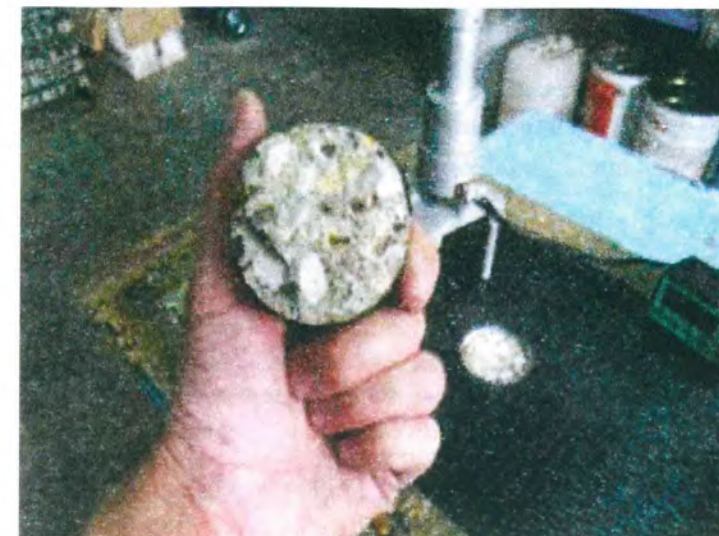
Рисунок Д.10 – Когезионное разрушение бетонной подложки
