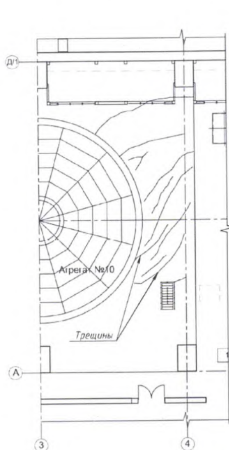
Рисунок Б.16 – Усиление перекрытия машинного зала здания ГЭС
