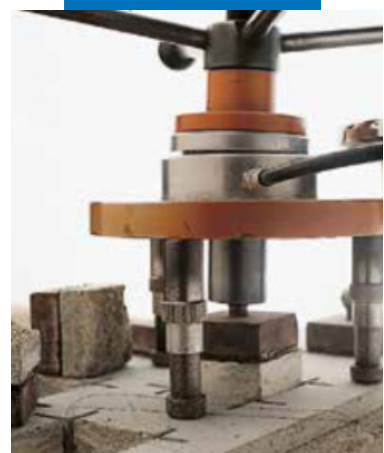
Испытание на адгезию SATTEC
