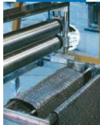
Impregnazione a macchina di MapeWrap C
