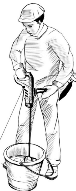
Перемешивание низкооборотистой дрелью с ворошителем
