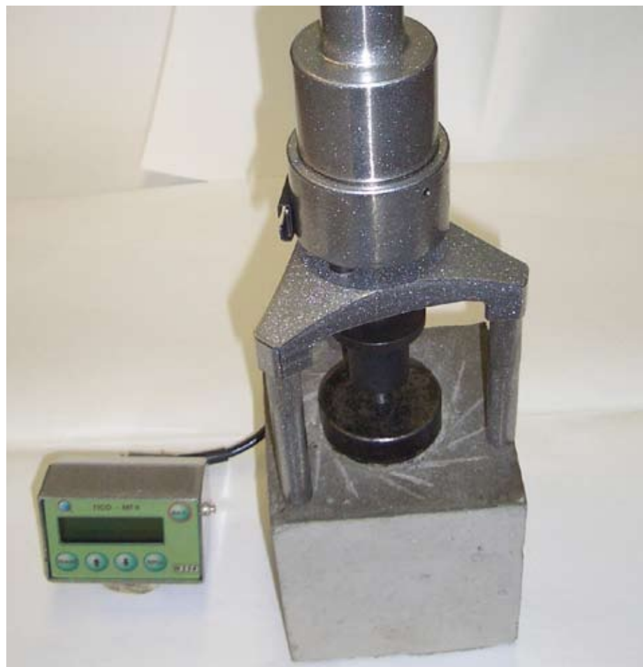
Рис. 1.4. Измеритель прочности сцепления (адгезии) PCS-10MG4.
