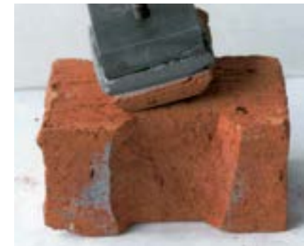
Рис. 4. Разрушение по телу кирпича при испытании на адгезионную прочность
