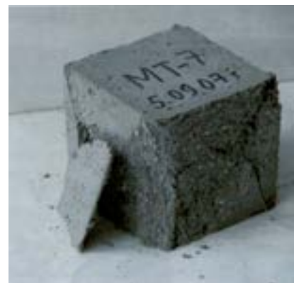
Рис. 1. Характер разрушения образцов при испытании на сжатие.
