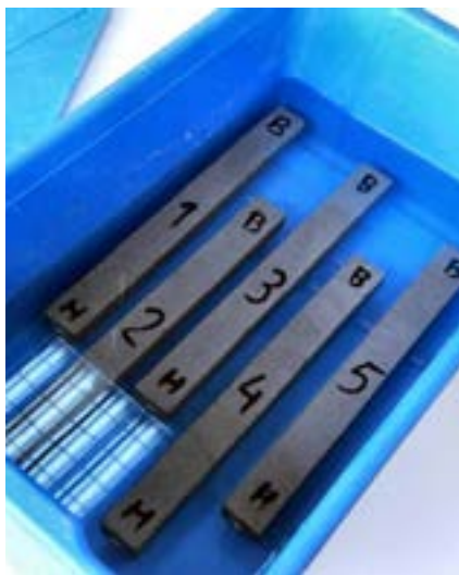
Фото 3. Хранение образцов в емкости для испытаний сульфатостойкости по ГОСТ Р 56687-2015
