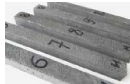
Фото 10. Образцы для испытаний сульфатостойкости по ГОСТ Р 56687-2015 после 3 месяцев испытаний в дистиллированной воде
