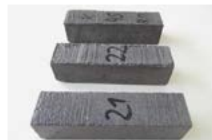
Фото 20. Контрольные образцы для испытаний сульфатостойкости по ГОСТ 27677-88 после 5 месяцев испытаний в питьевой воде
