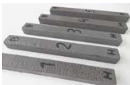
Фото 13. Образцы для испытаний сульфатостойкости по ГОСТ Р 56687-2015 после 4 месяцев испытаний в агрессивной среде
