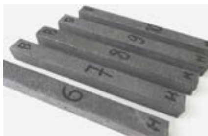
Фото 14. Образцы для испытаний сульфатостойкости по ГОСТ Р 56687-2015 после 4 месяцев испытаний в дистиллированной воде
