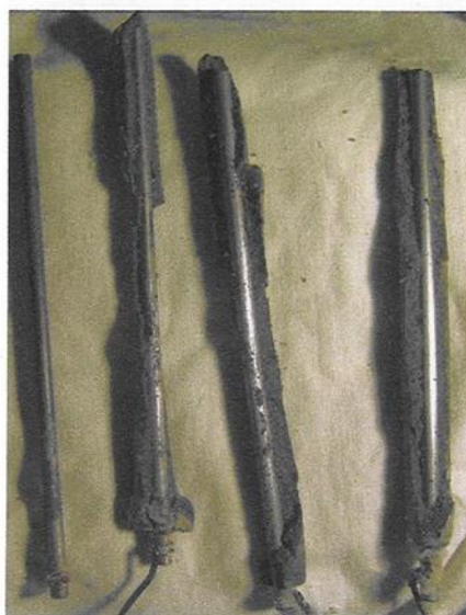
Рис. 3. Внешний вид поверхности стальных электродов после испытаний.
